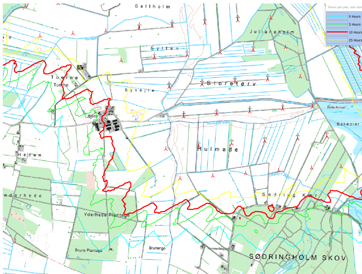
Figur 11: Skyggekurver med angivelse af reelle skyggetimer i et normalt år.
