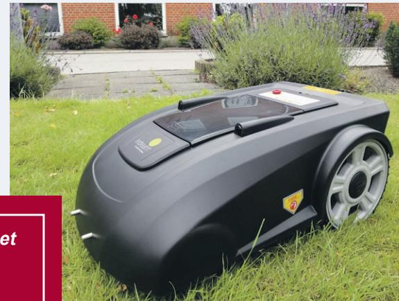
over en helt anden type robot. Nemlig en plæneklipper, der kører helt automatisk. Klipperen er elektrisk og larmer derfor næsten ikke. I yderkanten af græsplænen er der lagt en ledning i jorden, som maskinen registrerer. Så hver gang den når frem til yderkanten af græsset skifter den ret-
